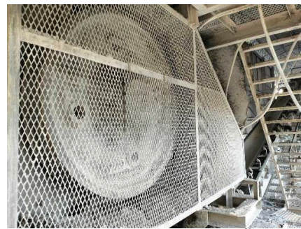
รูปที่ 2-42: การจัดส่วนปิดหรือแผ่นกัน (Guard) สำหรับเครื่องจักรกล
