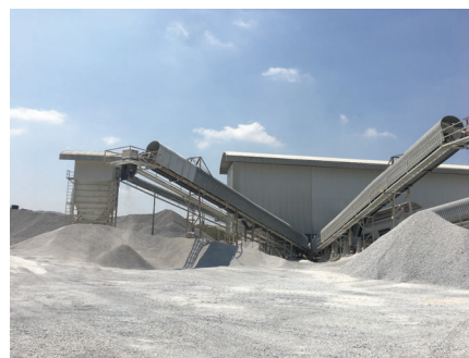
รูปที่ 2-23: การปิดคลุมอาคารโรงโม่หิน
