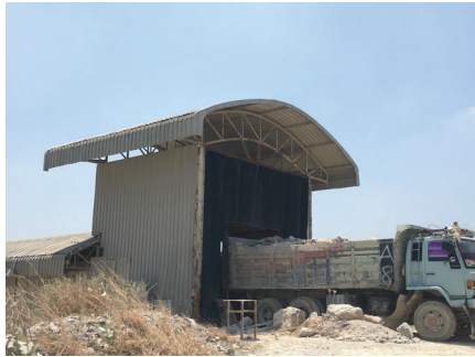
รูปที่ 2-24: การปิดคลุมถังรับแร่
