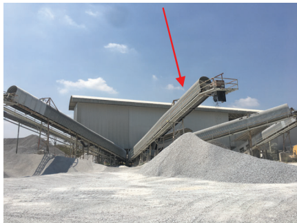
รูปที่ 2-26: การปิดคลุมสายพานลำเลียง
